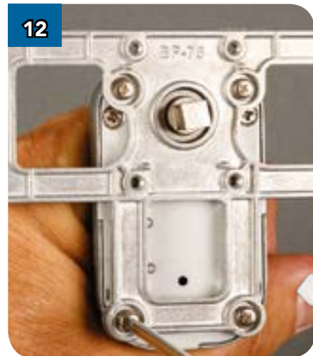
Повторите шаги 9–11 для трёх других винтов, после чего закрутите все четыре винта до упора.
