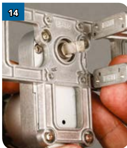
Совместите четыре штифта крепления двигателя с отверстиями в основании крепления подшипника...
