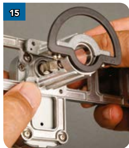
...и установите крепление подшипника на своё место так, как показано на фотографии.
