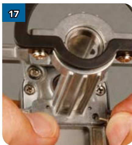
...вставьте винт в одно из крепёжных отверстий в основании крепления подшипника...
